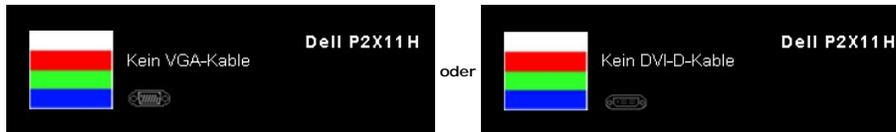
4. Diese Anzeige erscheint auch im Normalbetrieb, wenn das Videokabel getrennt oder beschädigt wird. Der Monitor schaltet **nach einer Nichtbedienug von 15 Minuten in den Stromsparmmodus**.
